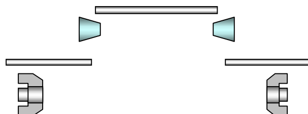
模板对拉件零件
