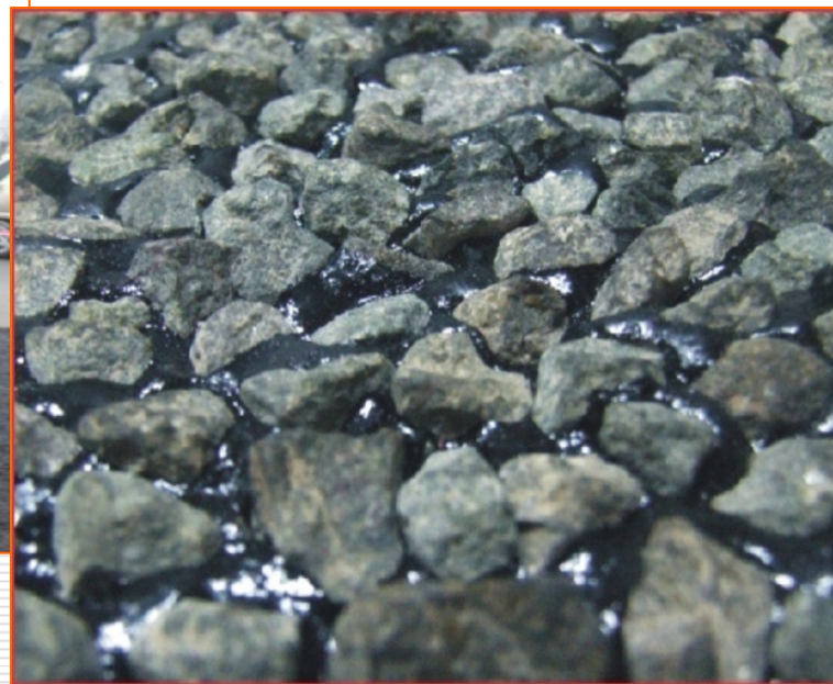
橡胶沥青封层（应力吸收层）
