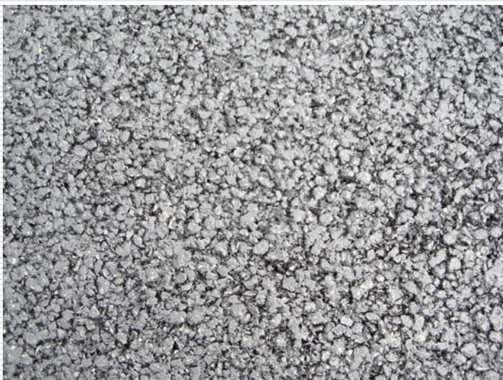
橡胶沥青SMA路面
