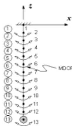
图7.17 用梁单元和集中质量单元模拟钻杆振动
