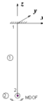
图7.9 用弹簧元和质量元模拟圆盘的扭转振动
