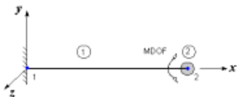
图7.13 利用杆单元和质量单元模拟圆盘的扭转振动
