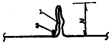
图 2.3.9(2) 单立咬口 1-每隔100mm冲元点；2-密封胶
