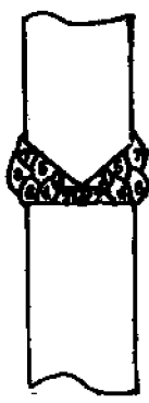
图 2.3.11(6) 焊接层次及顺序图
