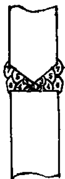
图 2.3.11(6) 焊接层次及顺序图
